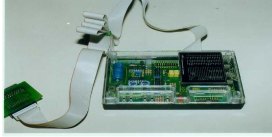
Resim 1 :Bilgisayarla Robot Arasında Kontrolü Sağlayan Arabirim Kartı
