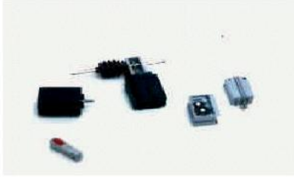
Resim 4: Raylı Sistemlerde Kullanılan D.C Motor ve Sonsuz Dişli
