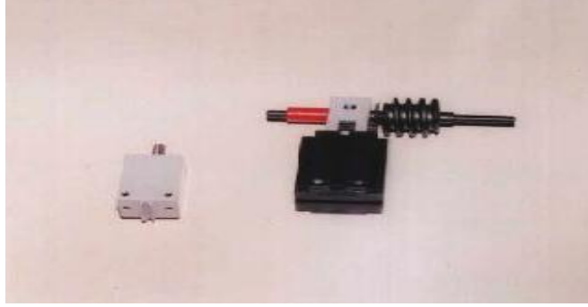
Resim 2: Robot kolunda kullanılan M3 motoru, sonsuz dişli, M5 motoru
