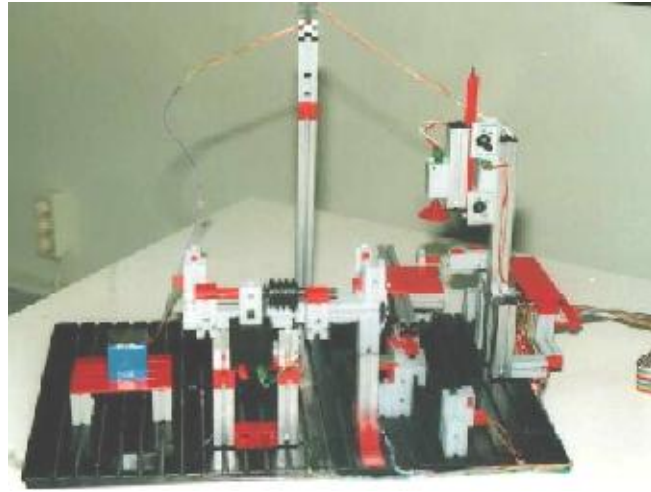
Resim 15: Robot kolu gövdesi, silme tezgahı, taşıma tezgahı monte edilmiş silme tezgahı otomasyonunun görünümü
