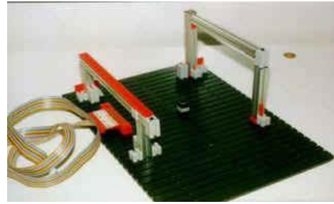
Yan Taşıyıcı Bantların Tabla Üzerine Montajı
