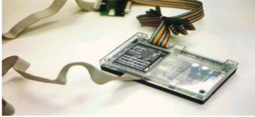
Resim 3. Bilgisayar ile Robot Seti Arasında Kullanılan Arabirim
