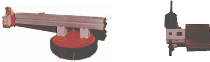
Şekil 20. Mıknatıs uçlu robot kol ve kolu çeviren motor, dişli sistemi.
