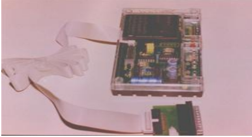
Şekil 2. Bilgisayarla robotun bağlantısını sağlayan arabirim.
